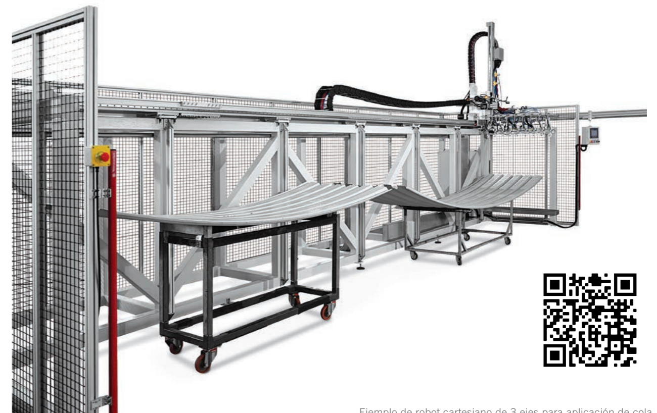
Ejemplo de robot cartesiano de 3 ejes para aplicación de cola
