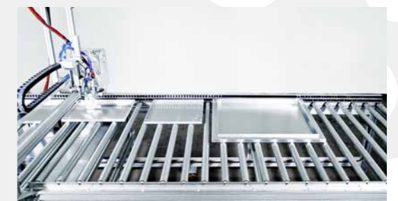
Esempio di robot per stesura colla su pannelli piani con o senza bordo
